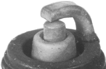
Рисунок 4.6 - Свеча зажигания в исправном состоянии
